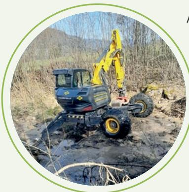
Aufgrund der Beschaffenheit des Bachbettes und der schlechten Erreichbarkeit der zu bearbeitenden Bereiche, wurden die Arbeiten in Zusammenarbeit mit der Firma HTB und deren „Kaiser Schreitbagger mit Sortiergreifer“ durchgeführt. Außerdem unterstützte unser Waldaufseher die Arbeiten mit der Motorsäge, den Abtransport führte unser Gemeindebauhof durch.
