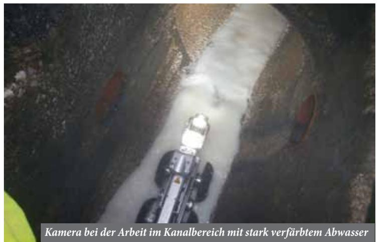
Kamera bei der Arbeit im Kanalbereich mit stark verfärbtem Abwasser
